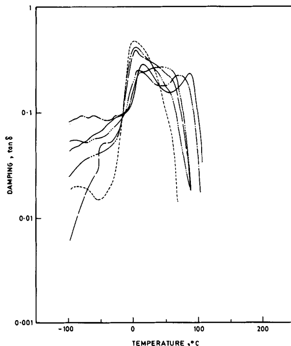
Figure 9 Temperature dependence of tan \delta of PVC/ENR/XNBR blends: (—) 50/50/25; (- · -) 50/50/50; (- · · · -) 50/50/75; (- - -) 50/50/100; (- · · · -) 50/50/125; (- - - - -) 50/50/150.
